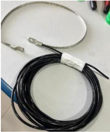
Fig. 7. Cabo de derivação conectado ao anel de cordoalha.
