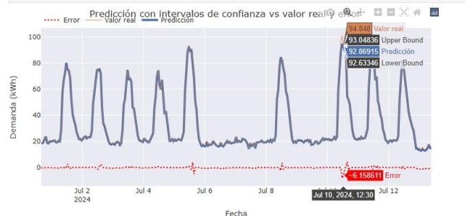
Fig.22. Curva de error de predicción *Random Forest* vs valor real de potencia activa (Comportamiento el 10 de julio del 2024).
